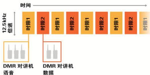
使用整个 12.5kHz 信道并将其划分为两个单独的时隙,以获得等效的6.25kHz 的频率。这可以将同一频道内的通话容量翻倍,从而在单个信道内同时支持两路数字通话。或者使用一个时隙支持语音通话,使用另一个时隙传输文本等数据。无需重新授权或调整频段便可获得两倍的容量,同时避免降低性能,或干扰相邻信道。
